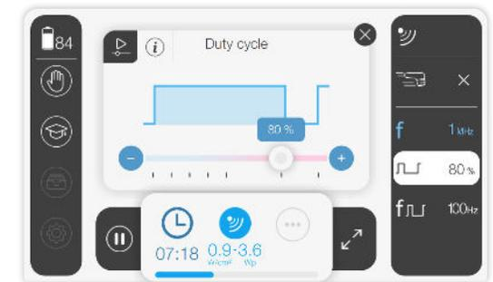
Un cadran virtuel unique pour régler l'intensité des ultrasons et la durée du traitement.
